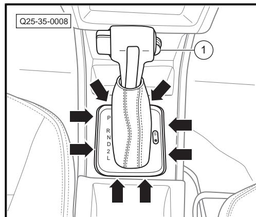
4. 脱开连接插头-箭头A-、-箭头B-, 向上掀起换档杆手柄盖板-1-。
