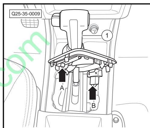
5. 使用工具撬起锁止圈-1-的固定卡-箭头-, 向下移动锁止圈-1-。
