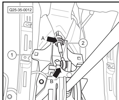
5. 断开换档操纵机构总成-1-的连接插头-箭头B-。
