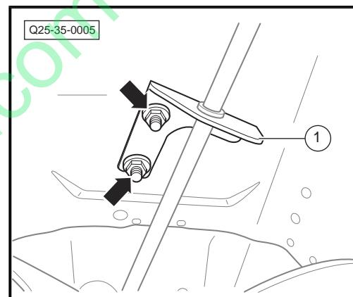
8. 旋出换档拉索总成-1-的固定螺栓-箭头-。
