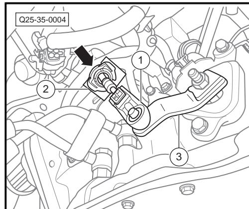
11. 使用工具从-箭头B-位置, 脱开换档拉索总成-1-与换档操纵机构总成-2-的连接。
