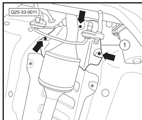
6. 旋出螺母-箭头-, 将后隔热罩-1-向后移至可旋出选换档拉索支架固定螺母位置即可。
