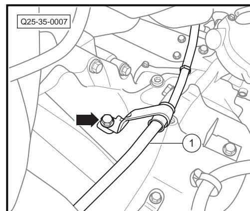
9. 用工具脱开换档拉索总成-1-与换档臂-3-的连接。
